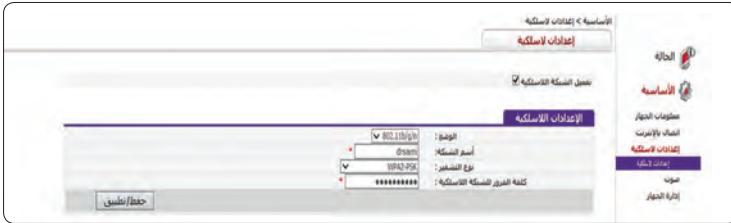
شكل (١-٢-٩): نافذة الإعدادات لقيم الاتصال اللاسلكي لجهاز المودم
